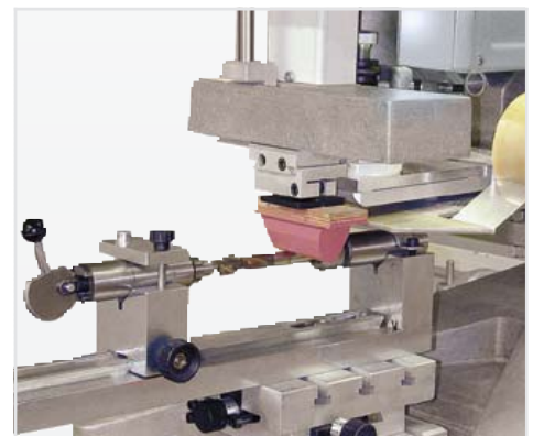
Reciprocatore tamponi SE 76 per stampa a rotolamento su Logica mi.micro Shuttle system SE 76 for rolling printing fixed on Logica mi.micro
