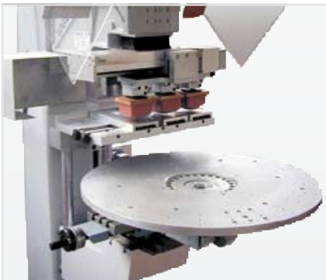
Reciprocatore tamponi SE 228 e tavola rotante TRCN 03 su Logica Micro LP Shuttle system SE 228 and rotary table TRCN 03 fixed on Logica Micro LP
