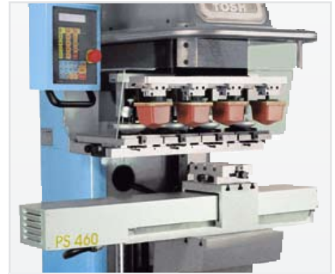
Indexore PS 460 e tavola ortogonale TO 100 su Logica 150 Indexer PS 460 and cross table TO 100 fixed on Logica 150
