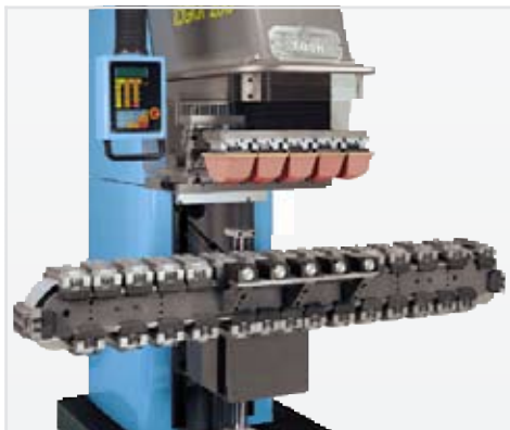
Convogliatore MEM-144 su Logica 250 Conveyor MEM-144 fixed on Logica 250
